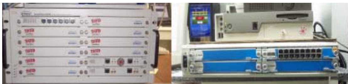
圖三： 測試儀器 Spirent SmartBits 6000B、Agilent Router Tester 900
